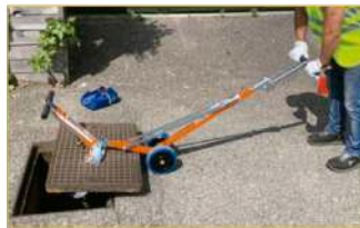
Utilisation 2 : soulèvement avec levier rabattable
