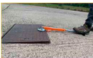
Déverrouillage grâce à sa forme spéciale
